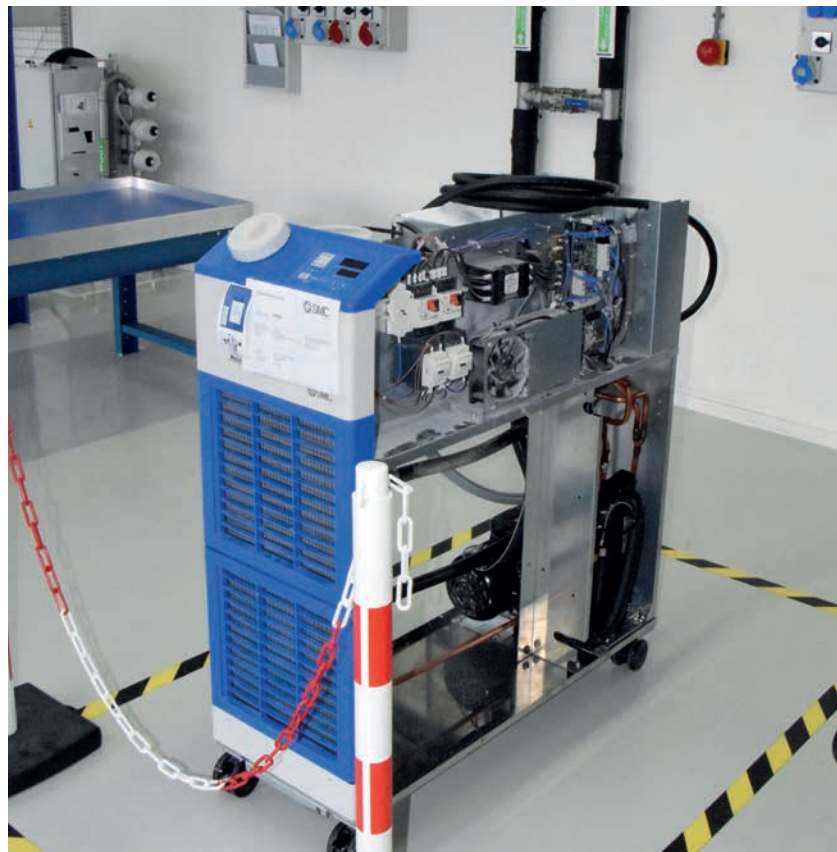
De SMC thermo-chillers worden in de semiconductor- en de medische industrie ingezet om machines of machineonderdelen te koelen of te verwarmen. In Eindhoven is een professioneel Chiller Repair Center ingericht (illustratie: SMC).
